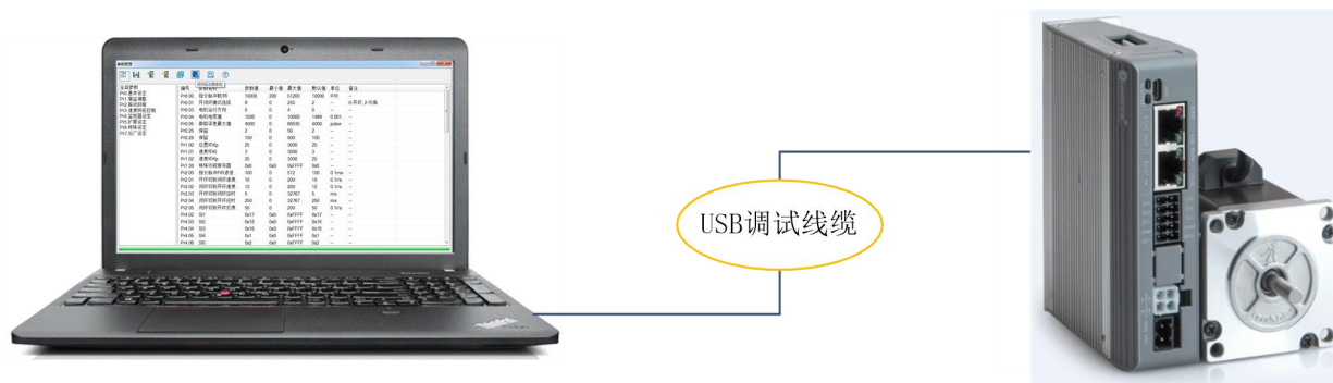
图 4-2 驱动器与 PC 的连接示意图
